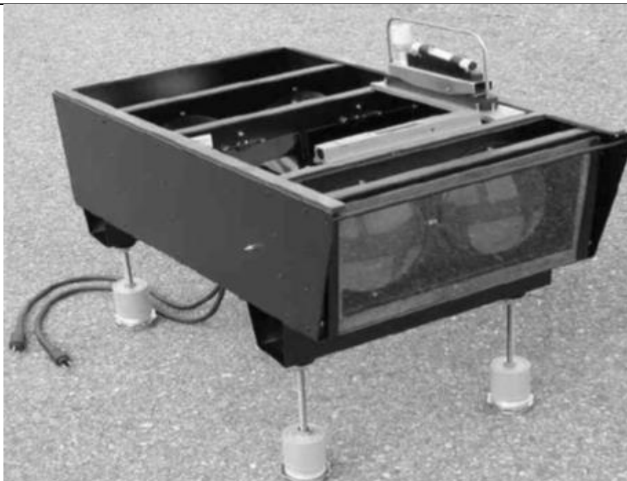
Fot. 5 Wskaźnik ścieżki schodzenia precyzyjnego dla kierunku lądowania 26L
